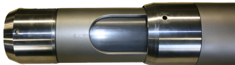
Casingrohr mit Linersonde (Linersonde zur besseren Darstellung geöffnet normal geschlossen)
