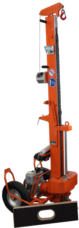
Rammsondiergerät mit aufgestelltem Mast
