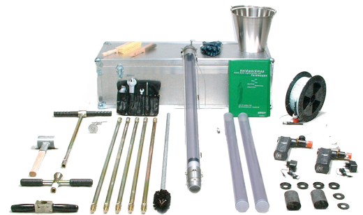
Beeker Sampler Set bis 5 Meter Tiefe
